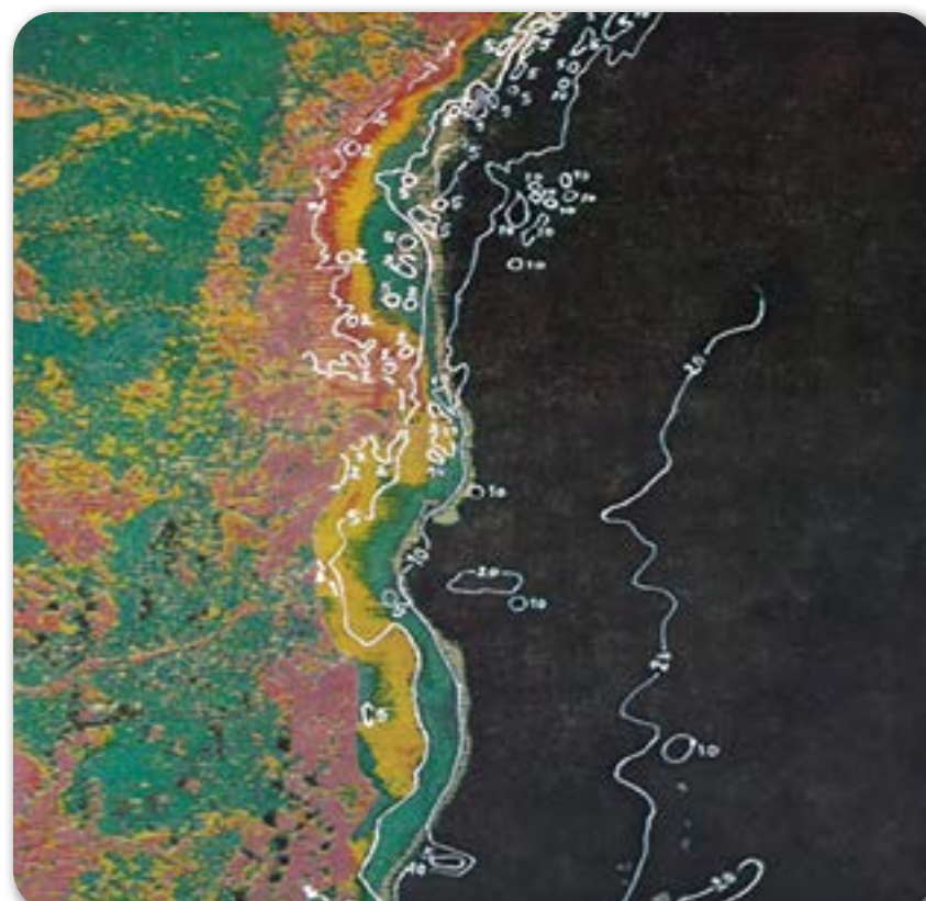
तूतीकोरिन तट के लिए उपग्रह-व्युत्पन्न बेथीमेट्री Satellite-derived bathymetry along Tuticorin coast
