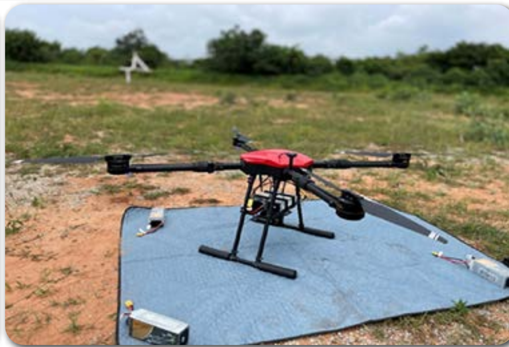
10 किलोग्राम पेलोड क्षमता वाला क्वाडकॉप्टर Quadcopter with 10kg payload capacity
