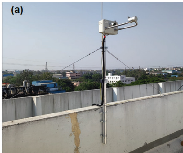
चित्र 2.1:: (A) लेजर वर्षण मॉनिटर(B) 7 मई 2024 को LPM द्वारा मापी गई वर्षा दर की समय श्रृंखला Figure 2.1.(a) Laser Precipitation Monitor, (b) time series of rain rate measured by LPM on 7th May 2024.
